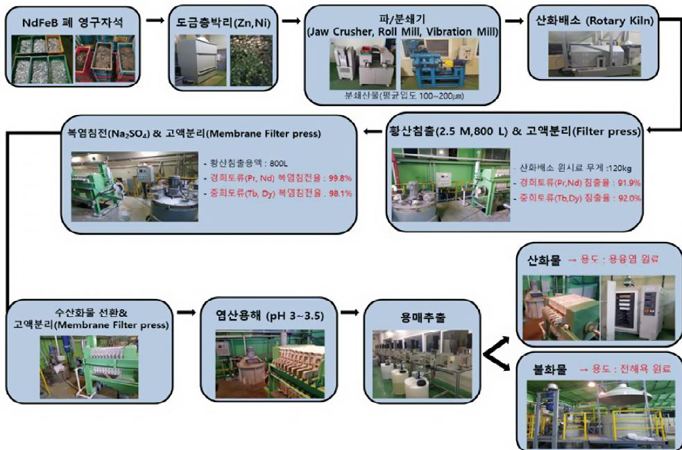
[그림 10] 폐 영구자석 재활용 Pilot-Plant 공정도
